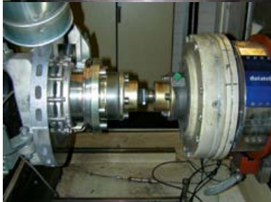
Telemetriesystem integriert in den Prüfstandsflansch (Schenck Pegasus PKW-Bremsenprüfstand)
