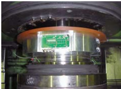
Telemetriesender montiert auf Prüfstandswelle (geteilter Senderträger für Klemmontage)
