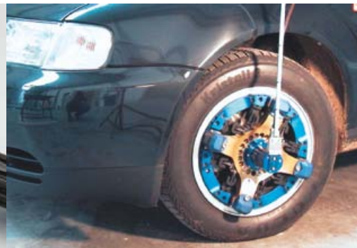
6-Komponenten Messrad mit telemetrischer Signalübertragung
