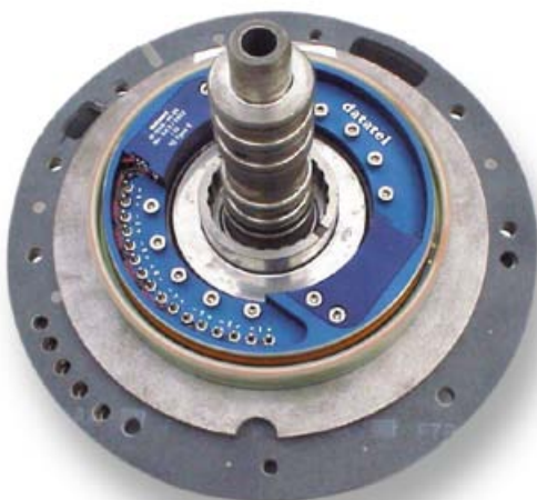
8-Kanal Temperaturmessung im Automatikgetriebe
