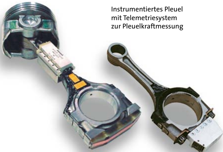
8-Kanal Telemetriesystem zur Kolbentemperaturmessung
