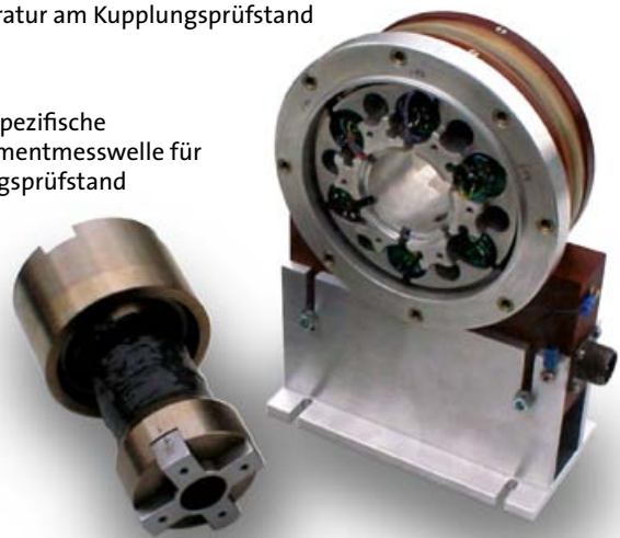
Telemetriesystem zur Messung von Drehmoment, Drehwinkel und Temperatur am Kupplungsprüfstand
