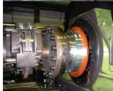
Telemetriesystem zur Messung von Drehmoment, Drehwinkel und Temperatur am Kupplungsprüfstand
